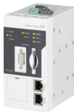
Fieldgate SFG500 – Basic-Modus Ethernet-Gateway mit integriertem Webserver und adaptive PROFIBUS Master Klasse 2 für die Kommunikation mit PROFIBUS-Geräten.
